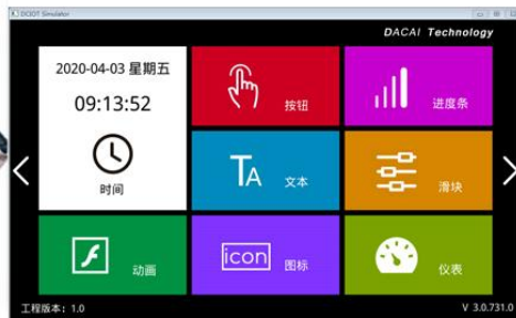
图 11-2 用户单片机串口与“虚拟串口屏”联机调试
